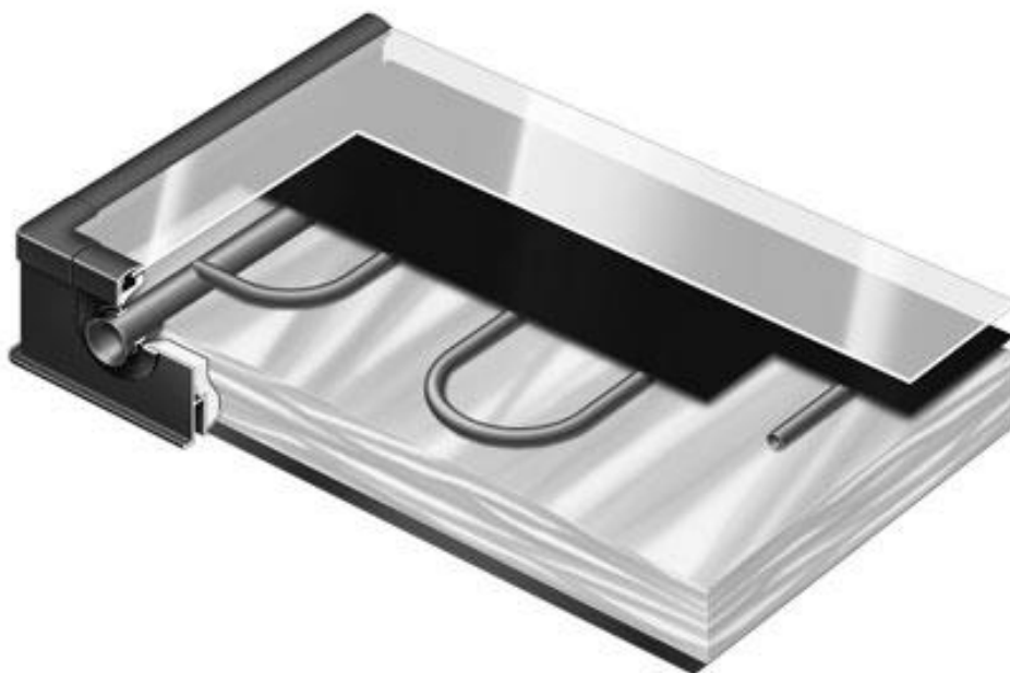
Рисунок 2.3 – Будова плоского сонячного колектора
