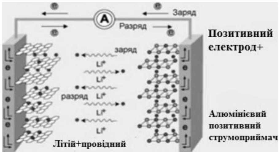
Рисунок 4.1 – Схема роботи літійового акумулятора
