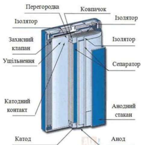
Рисунок 4.2 – Схема конструкції літійового акумулятора
